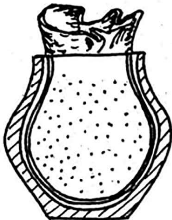
Рис. 1. Спосіб формування посудини за допомогою торбинки з піском [2, с. 30].
