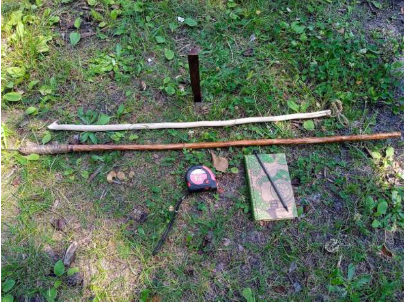
Рис. 2. Загальний вигляд експериментального обладнання: списометалка (зверху), дротик з деревком і наконечником (знизу)
